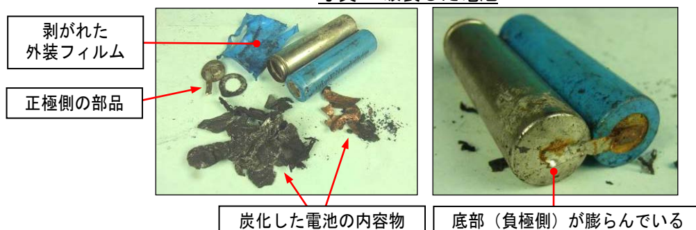
写真 2. 破裂した電池
